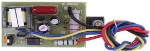
MODULO FUENTE AJUSTABLE DE 5 A 24V PARA TELEVISORES LCD Y LED UNIVERSAL
